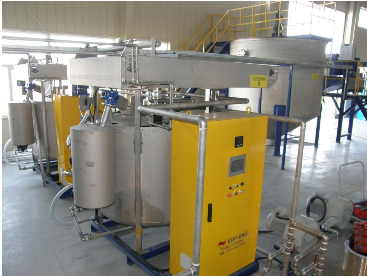
동희산업 중국 염성(염청) 공장 도장공정 무방류 폐수처리 시스템 : 일일 100톤
