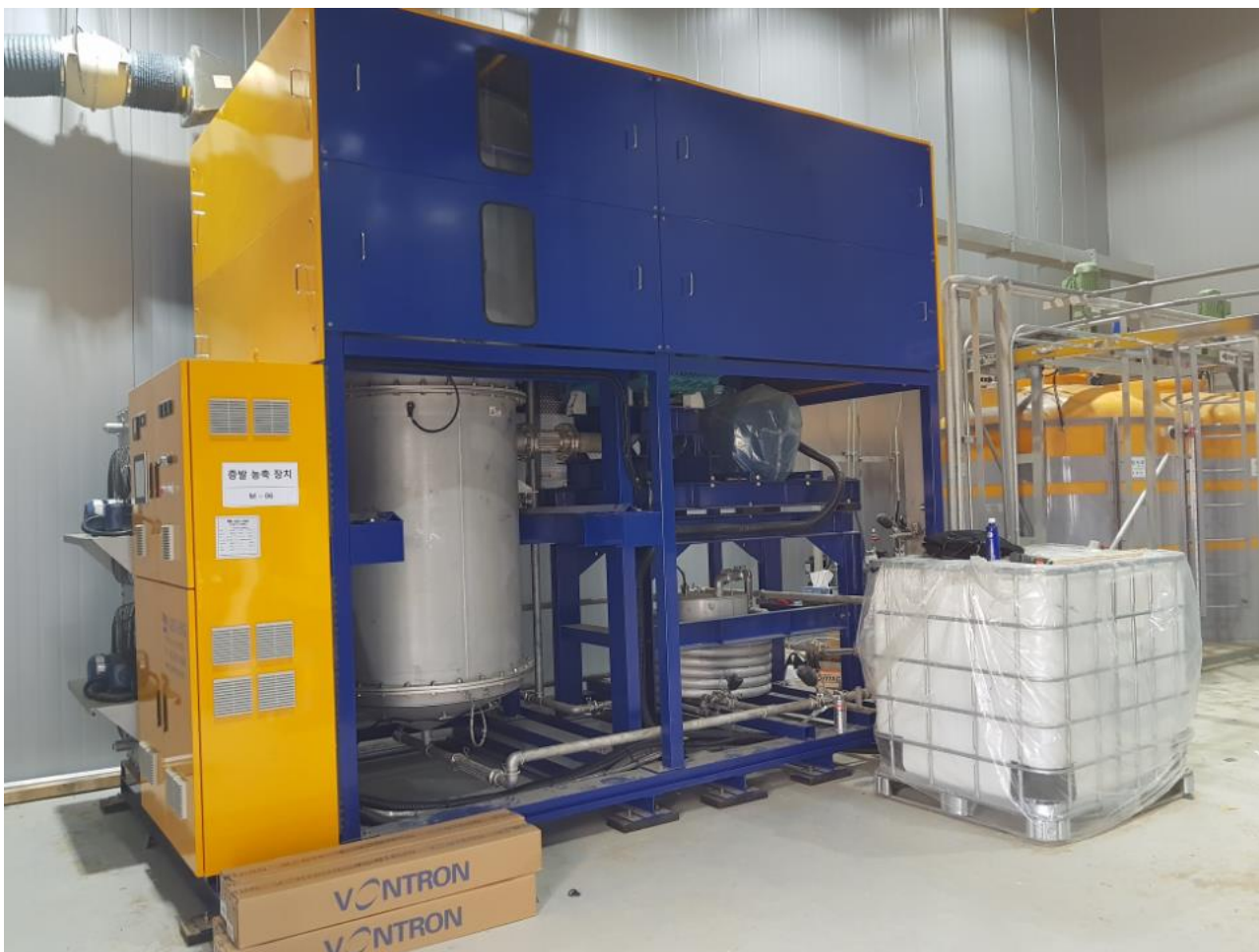
지오스에어로졸 무방류 폐수처리 시스템 : 일일 10톤
